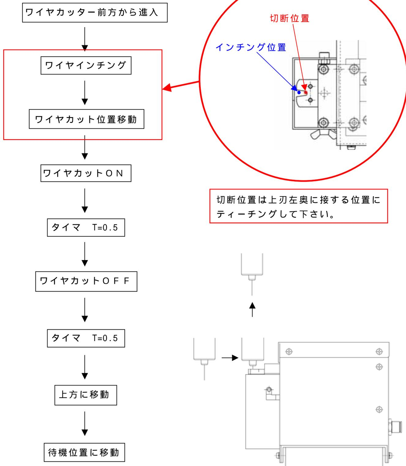
ワイヤカットON/OFFはロボット外部出力からソレノイドバルブをON/OFFする事で制御して下さい。
