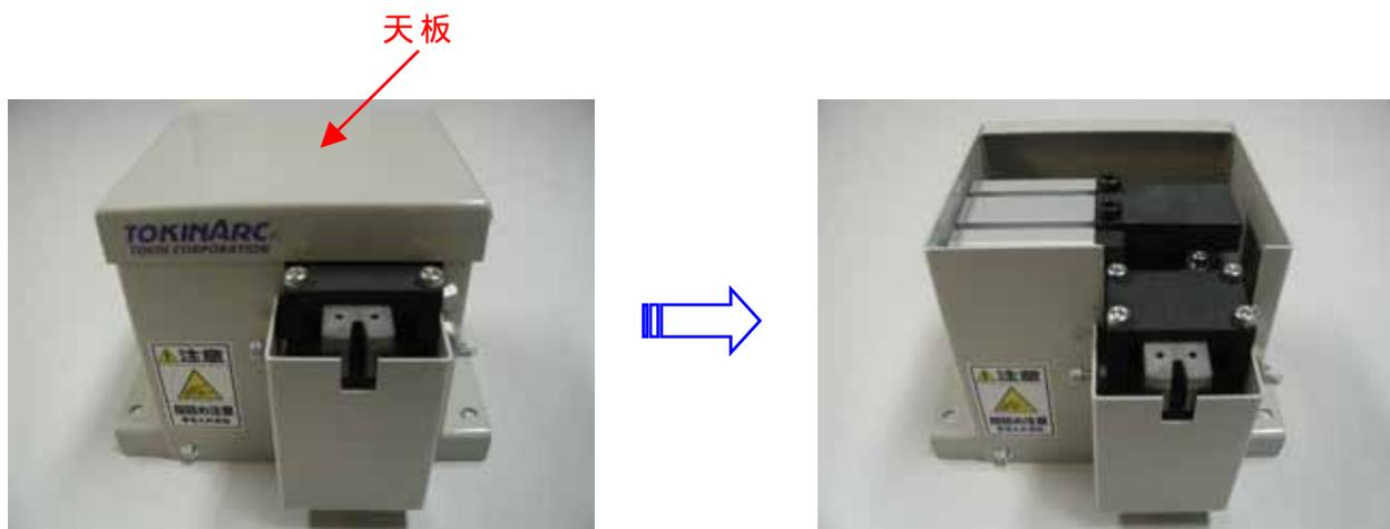
2. カッターホルダー（上）を固定している4本の六角穴付きボルトを外してカッターホルダー（上）を真上に引き抜いて下さい。
