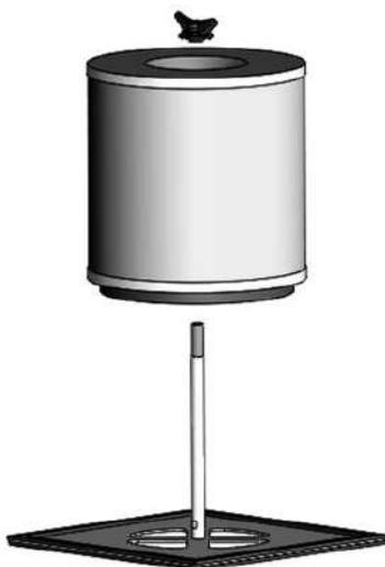
④新しいカートリッジフィルターを組付け、蝶ナットで固定する。
