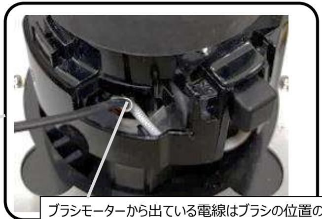
ブラシモーターから出ている電線はブラシの位置の左隣の穴から出るようにし、反対側のブラシモーターから出ている電線もブラシの位置の左隣の穴から出るようにしてブラシモーター上部の蓋を組付ける。
