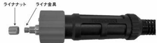
ライナ金具が写真の位置になるようにセットしてからライナナットをねじ込みライナを固定してください。ライナナットは手で軽く締め付けるだけで固定できますのでスパナ等の工具は使用しないでください。
