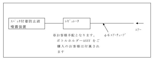
ボトルホルダーASSYをご購入のお客様は、ボトルホルダーに取付けてある圧力調整器(レギュレータ)のワンタッチ継手に外径 φ 6 のエアーチューブを 差し込んでください。
