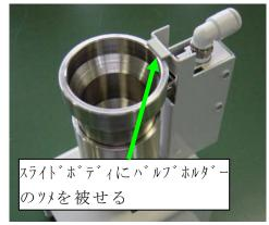
4) 清掃後、スプリングをセットしスライドボディを取付け、バルブホルダー にてスライドボディが抜けないように固定してください。
