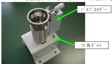
2) 六角穴付きボルトを緩めると、バルブホルダーが後傾します。 噴霧装置のスライドボディを上方へ引き抜いてください。
