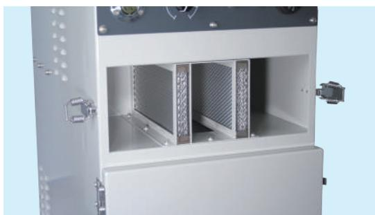
標準サイズのカートリッジフィルター(1個)とスパッタ侵入防止用のメタルフィルター(2セット)を標準装備。ヒューム発生量が多い溶接条件でも対応可能。
