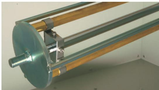
フィルターの目詰まりによる吸引風量の低下に対応するために、エアローパイプをフィルター内側で回転させるフィルター清掃機能を搭載しています。
